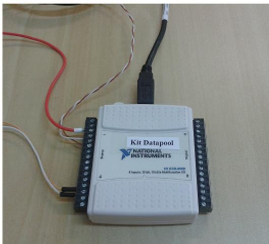
**Figura 12 – Placa de aquisição de sinais.**
