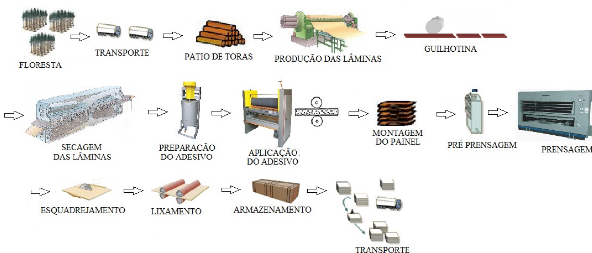
Figura 2 – Fluxograma de Produção dos Painéis de Compensado Fonte: GHELLER, 2012.
