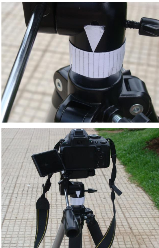
Figura 35 - Aparato utilizado para se medir graus. Cada risco equivale a 10 graus. Fonte: Autoria própria.
