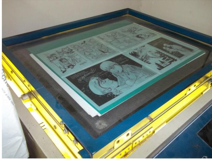
**Figura 22 – Processo de gravação da chapa metálica *Offset***
