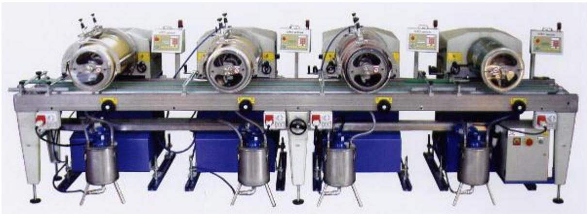
**Figura 31 - - Máquina de Serigrafia Rotativa**
