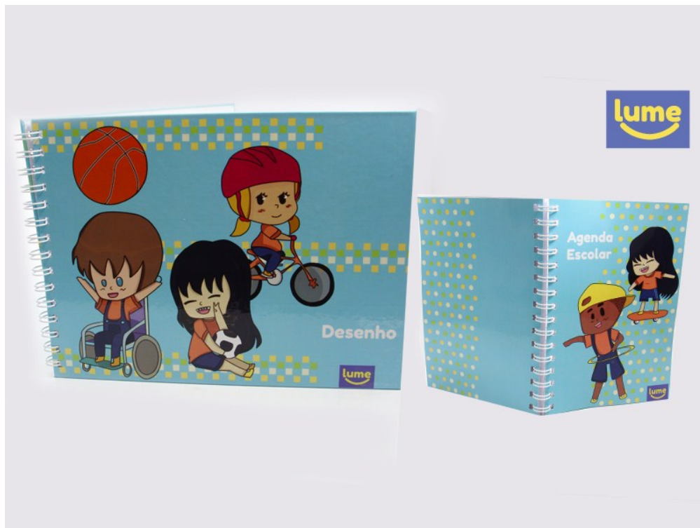
Figura 79 - Cadernos produzidos em encadernação wire-o e laminação a quente. Fonte: A autora
