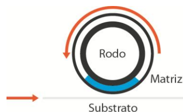
Figura 34 – Mesa de impressão rotativa Fonte: A autora (2012).
