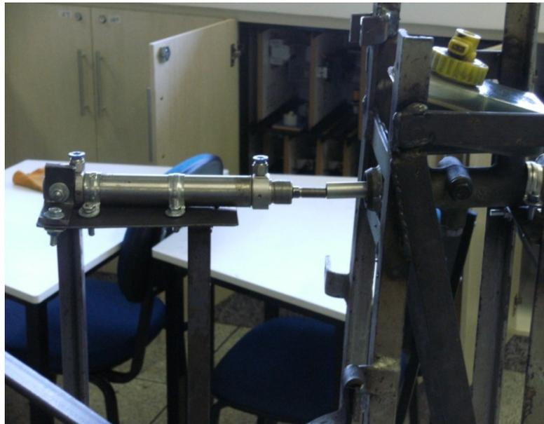
Figura 5 - Cilindro pneumático utilizado nos testes do protótipo inicial
