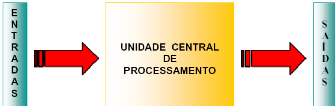
Figura 5 – Estrutura básica de um CLP
