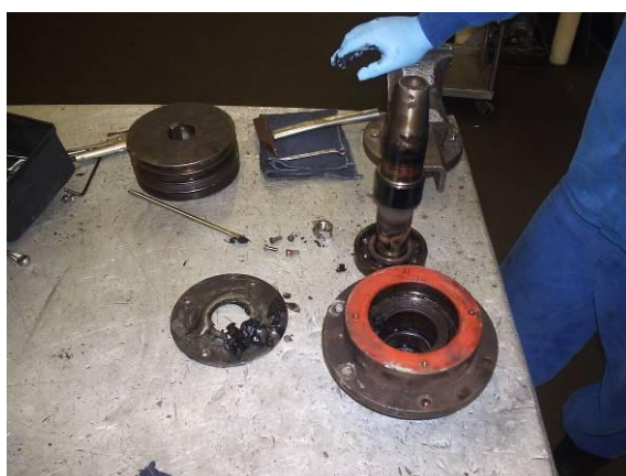
Figura 26 - Troca dos rolamentos da turbina.
