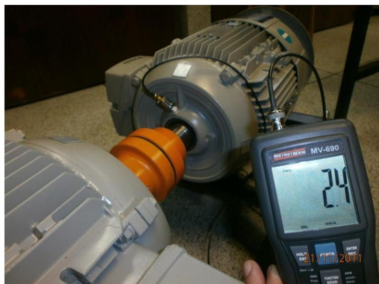
Figura 32 - Primeira medição no ponto axial dianteiro da MP.
