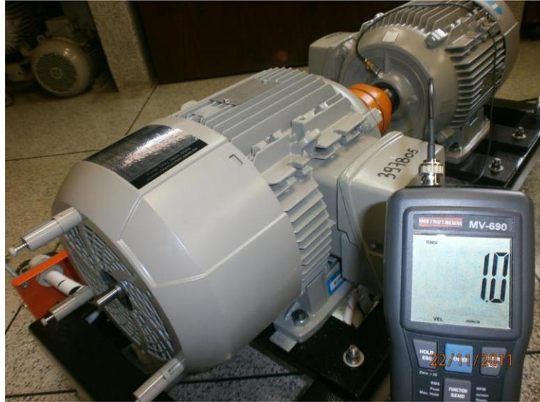
Figura 33 - Segunda medição no ponto axial dianteiro da MP.
