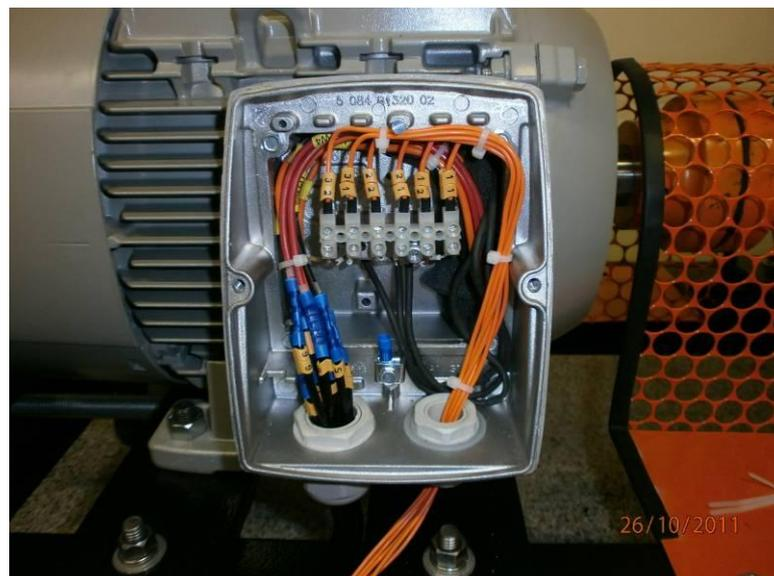
Figura 22 - Ligações das bobinas e dos PT100 na caixa de ligação.
