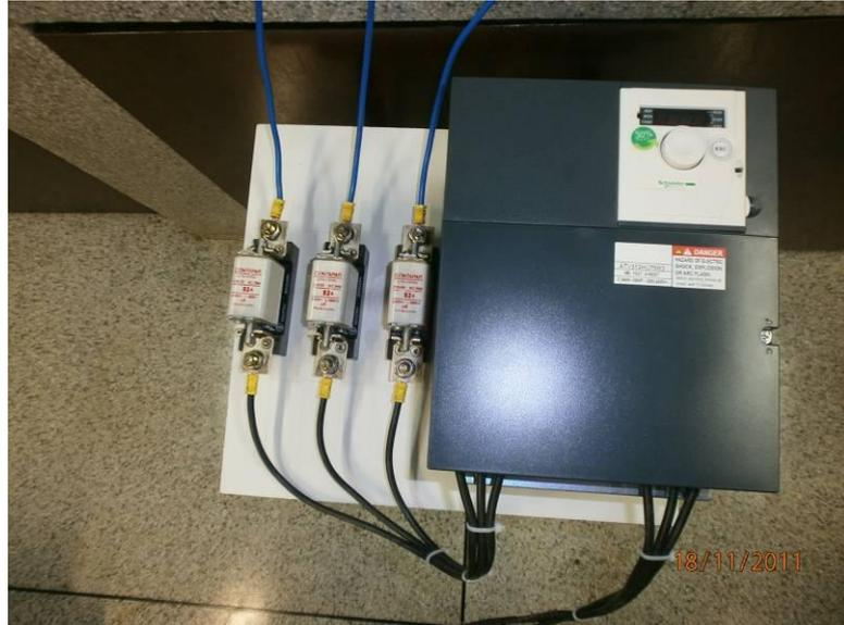
**Figura 25 - Montagem dos fusíveis e do inversor de frequência.**
