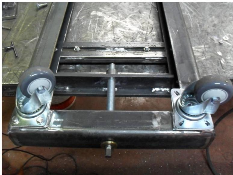
**Figura 14 - Rodas fixadas na base.**
