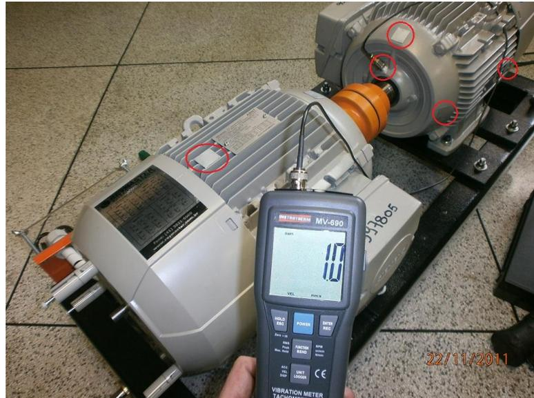
Figura 27 - Pontos de medição da vibração nas máquinas.
