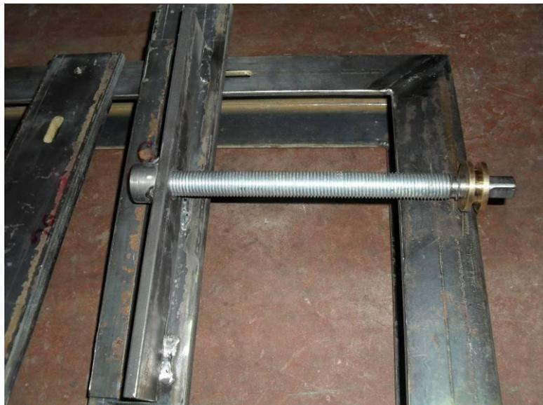
**Figura 12 - Fuso para movimentação das máquinas.**
