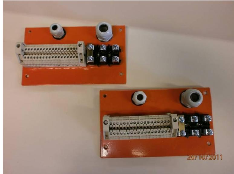
Figura 21 - Chapa de montagem.
