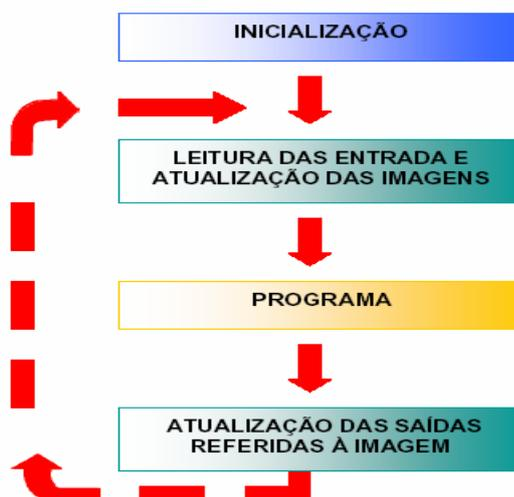
**Figura 1 - Ciclo de processamento**
