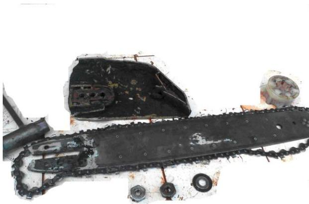
**Figura 14 – Componentes da motosserra**
