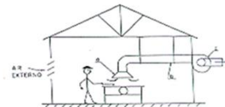
Figura 2: Sistema de Ventilação Local Exaustora Fonte: www.ebah.com.br
