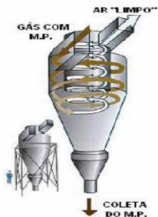
Figura 3: Funcionamento de um Ciclone
