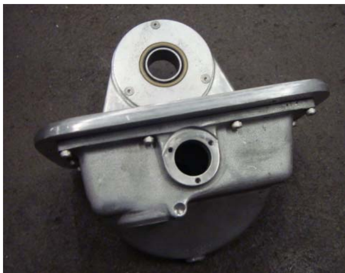
Figura 17: Caixa do mandril com reservatório de óleo.
