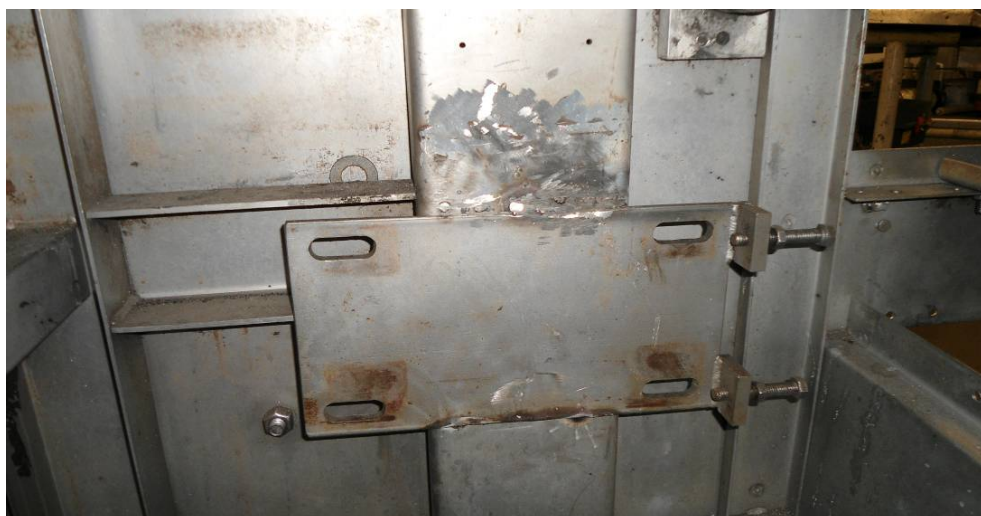
Figura 23: Base do motor modificada.
