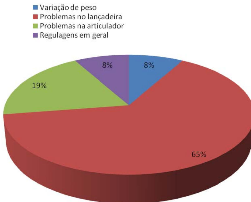
Figura 32: Gráfico dos principais problemas da máquina reformada.
