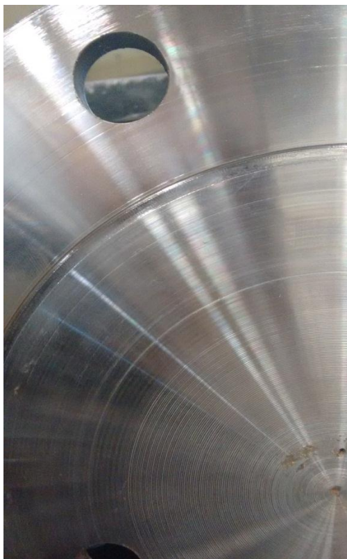
Figura 4- Tampa após a abertura dos rebaixos.
