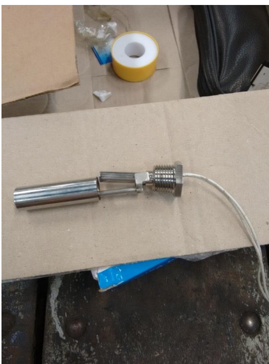
Figura 8 - Sensor de nível na posição alta.
