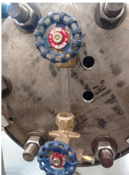
Figura 9- Tampa Com os Furos dos Sensores
