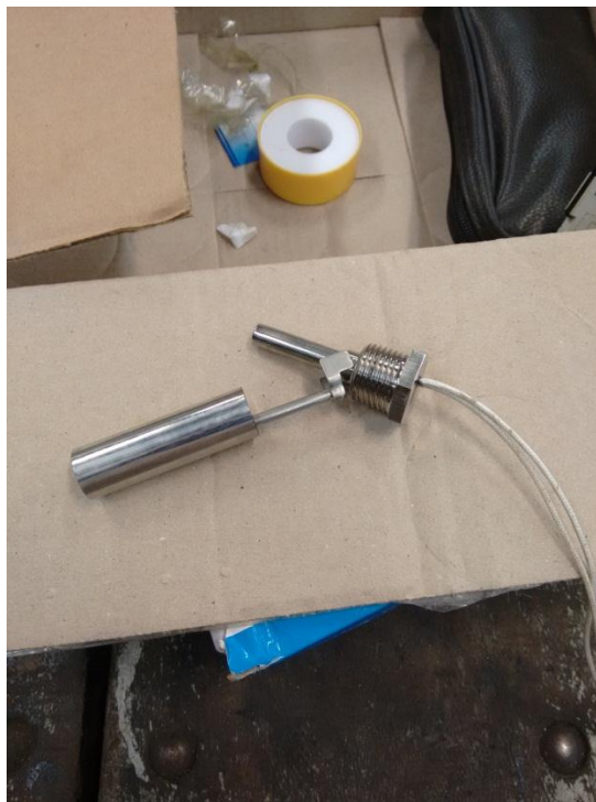
Figura 7 - Sensor de nível na posição baixa.
