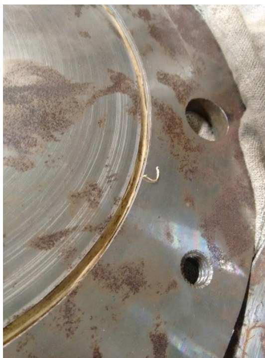
Figura 6- Aplicação da junta de papel.
