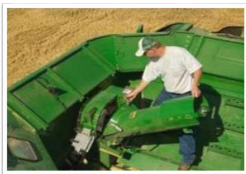
Figura 7: Sem-fim de Carga sendo Elevado para a Posição de Operação. Fonte: John Deere Training – Sistema de Armazenagem (2010).
