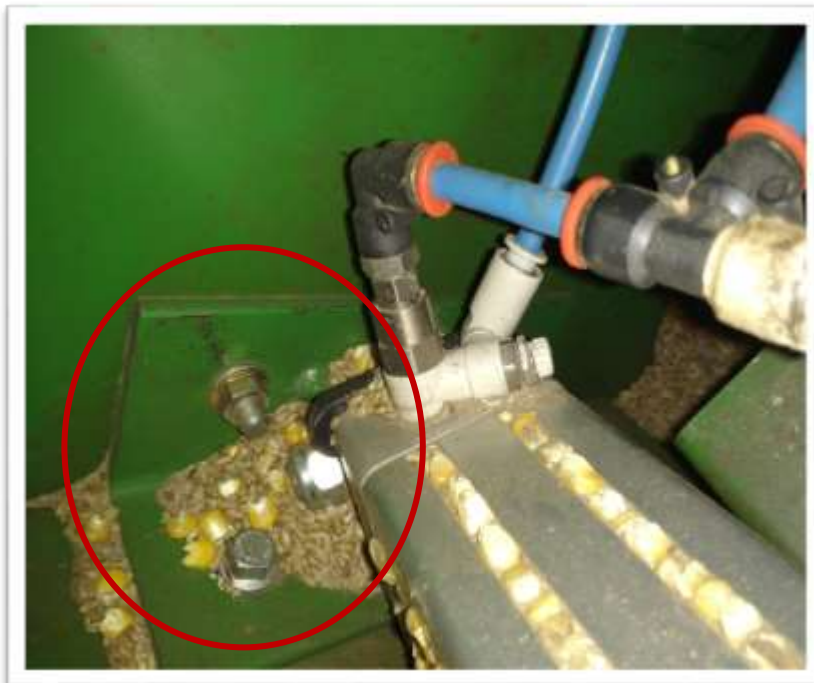
Figura 26: Suporte Inferior do Atuador Pneumático. Fonte: Autoria própria.
