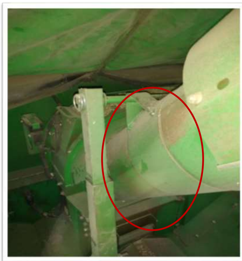
Figura 23: Detalhe do Suporte Abraçadeira do Sem-fim montado. Fonte: Autoria própria.
