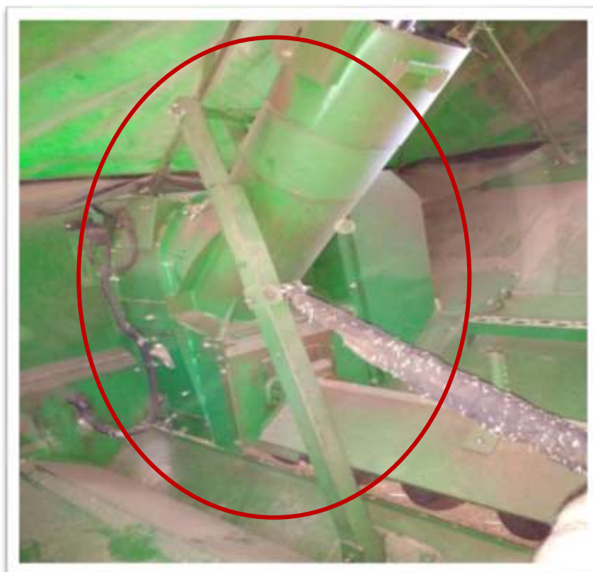
Figura 25: Barra de Elevação (trava mecânica). Fonte: Autoria própria.
