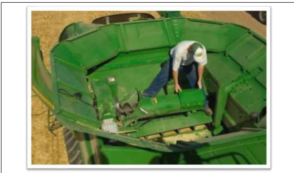
Figura 6: Dispositivo Sem-fim sendo colocado em Posição de Descanso. Fonte: John Deere Training (2016).
