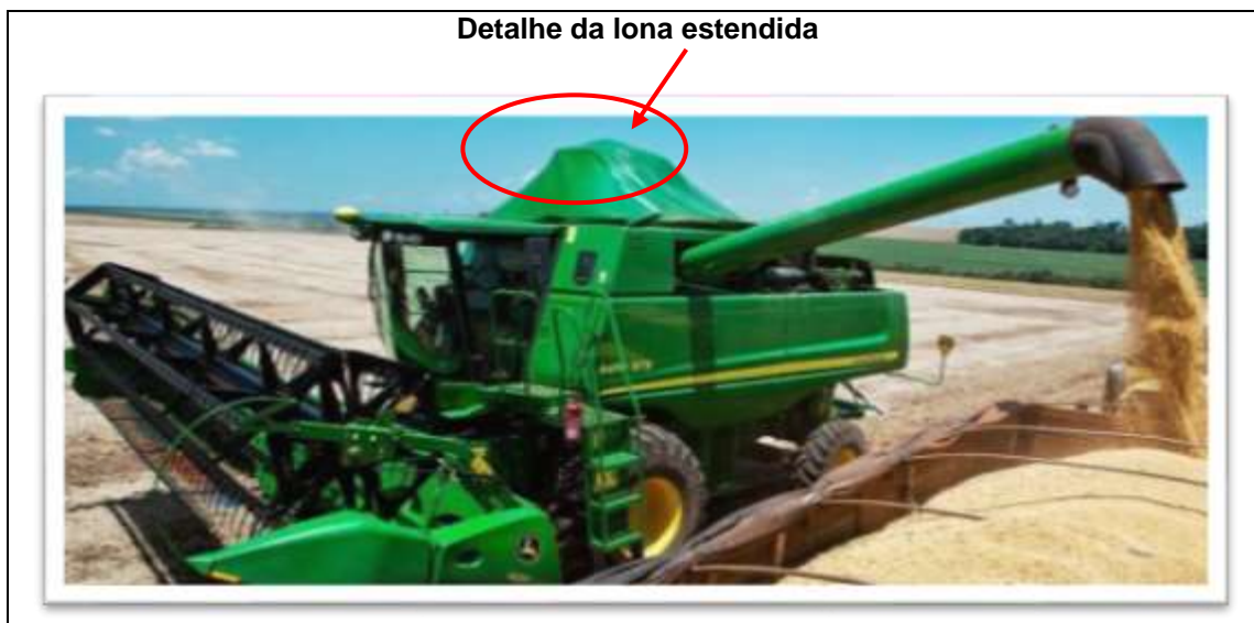
Figura 5: Colheitadeira STS Realizando a Descarga do Tanque Graneleiro. Fonte: Blog Caminhoneiro.
