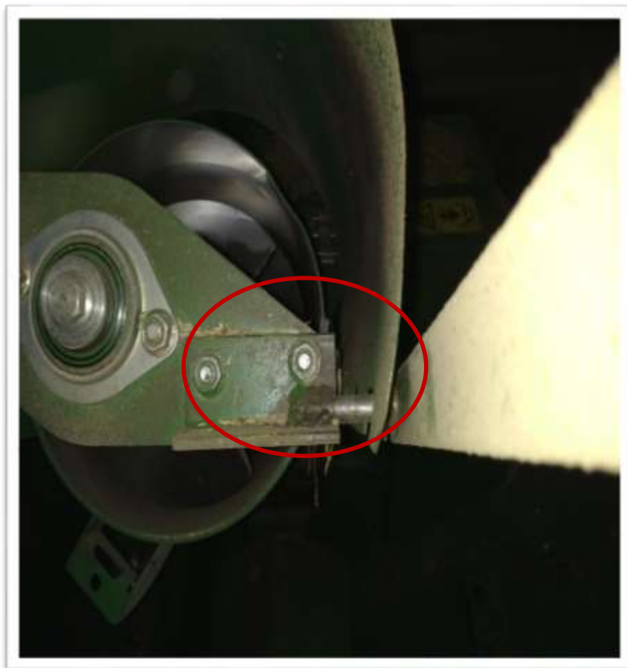
Figura 28: Suporte Responsável pela Movimentação da Base Octogonal. Fonte: Autoria própria.
