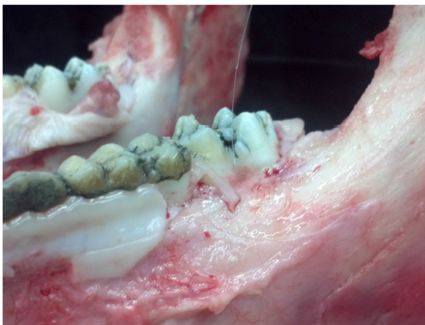
Figura 17 – Rede de Bragg em fibra ótica fixada na região entre o ligamento periodontal e o osso alveolar
