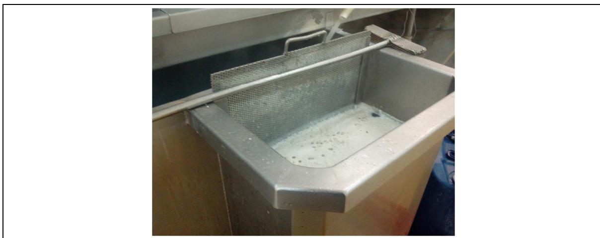
Figura 27 – Nova grade lateral com chapa com furo de 5 mm Fonte: Autores.
