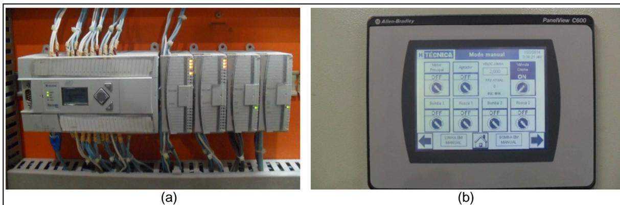
**Figura 7 – CLP (a) e Tela IHM (b) da máquina recheadora**
