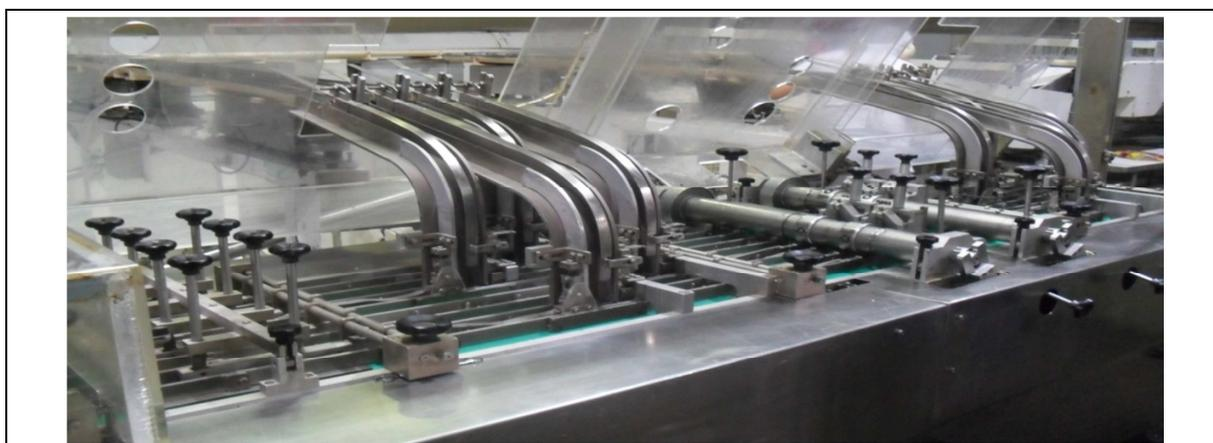
**Figura 8 – Guias da máquina recheadora**
