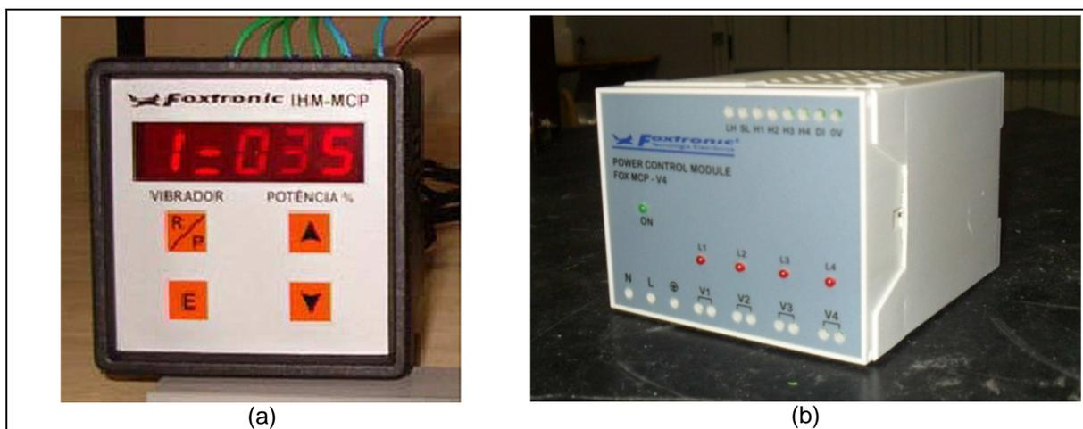
Figura 4 – (a) Controlador IHM-MCP, (b) Módulo de controle de potência modelo MCP-V4
