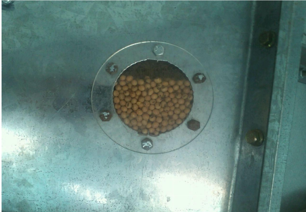
Figura 4 - Visor de Acrílico Inferior
