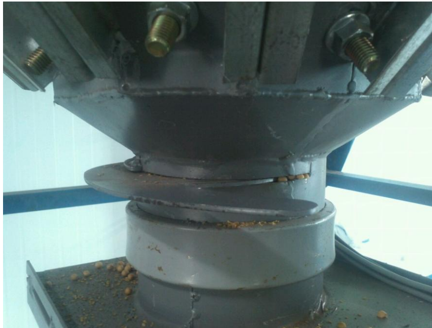
Figura 2 – Registro Faca Manual
