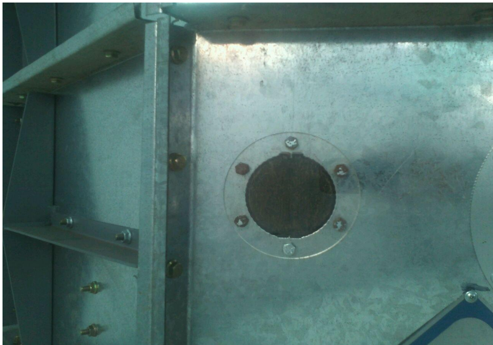
Figura 3 - Visor de Acrílico Superior
