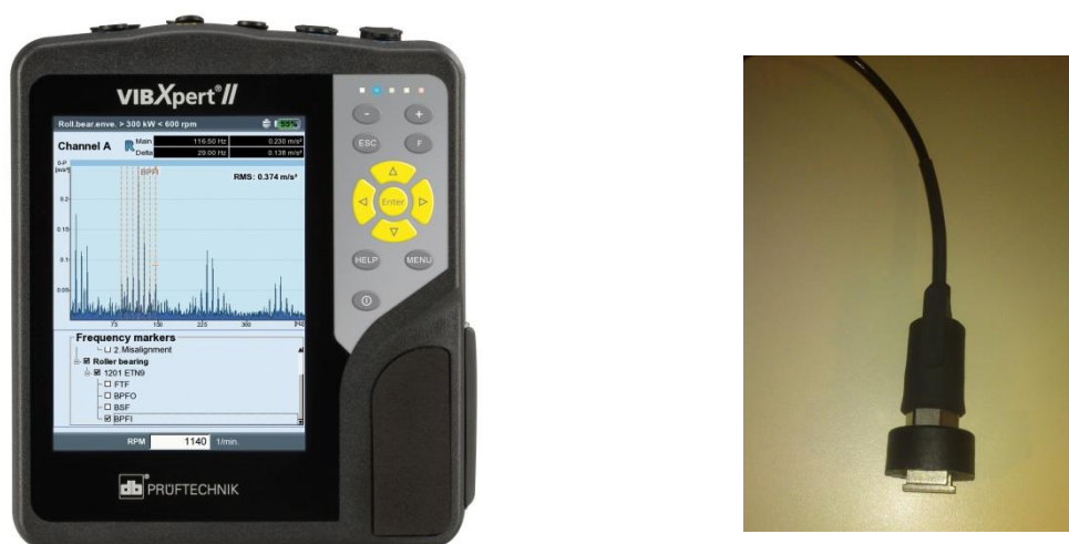
Figura 21: Em (a) Aparelho VIBXPERT II, em (b) Acelerômetro. Fonte: Pruftechnik (2010), e Autoria própria.
