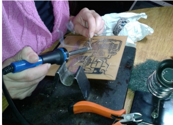
Figura 20: Soldagem dos componentes
