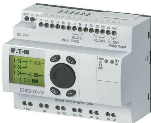
Figura 2 - CLP compacto EATON. Fonte: Eaton (2012).
