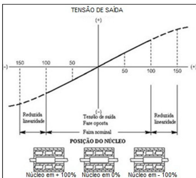
Gráfico 1. Modelo característico de resposta de um sensor LVDT Fonte: MEYDAN (1992)
