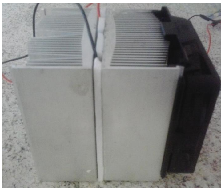
Figura 22 - Novo sistema de fixação
