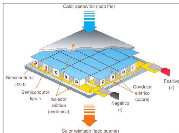
Figura 11 - Funcionamento interno de um módulo termoelétrico Fonte: www.peltier.com.br
