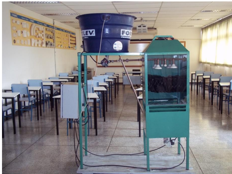
Figura 12 – Torre de resfriamento.
