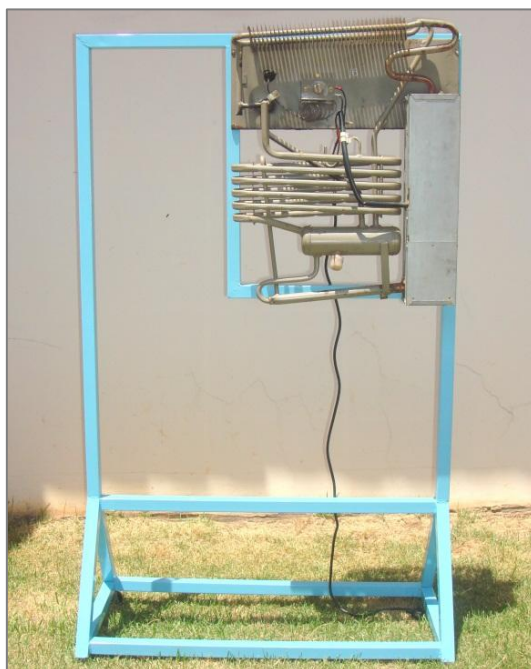
Figura 4. Sistema de Absorção fixado à bancada.
