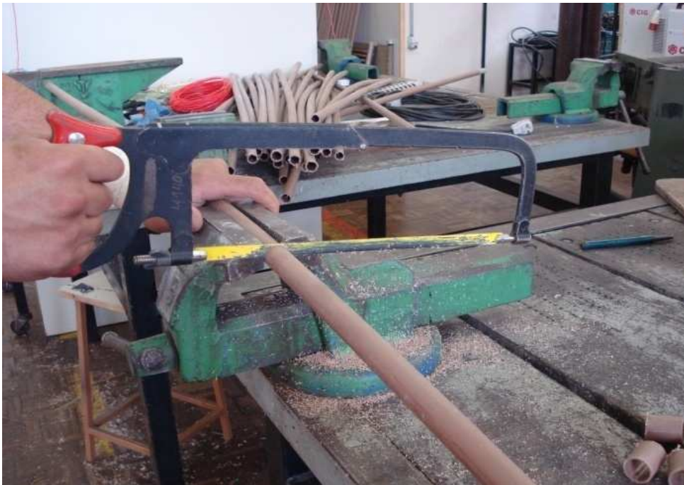
Figura 1 – Corte dos canos de PVC
