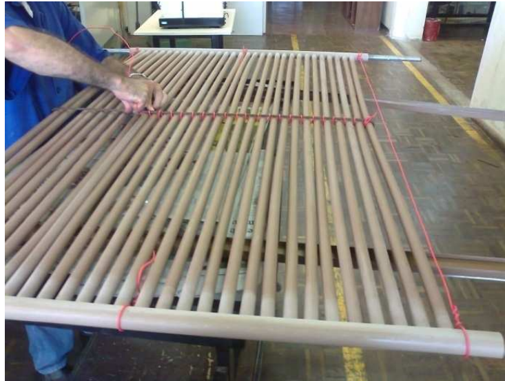
Figura 5 – Amarar do meio da placa para dar resistência
