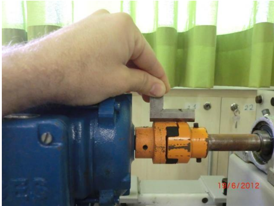
Figura 11 - Alinhamento utilizando régua de luz
