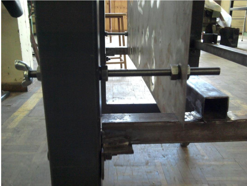
Figura 6 - Detalhe da barra rosqueada e posicionamento do painel inferior
