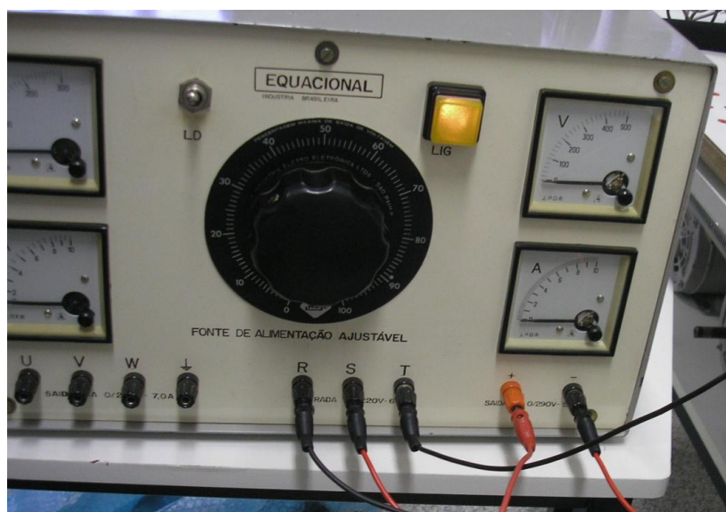
Figura 19 - Fonte de tensão utilizada nos ensaios de carga
