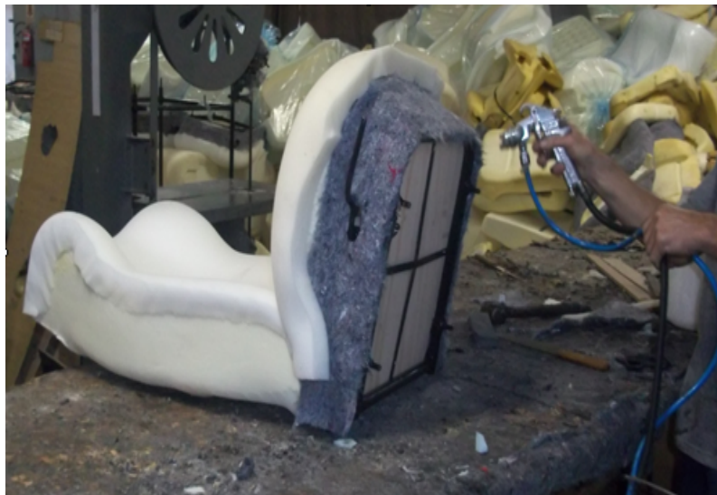
Figura 9-Preenchimento de espumas nos bancos revestido com compensado Fotografia-Simoni Castro Lessa Variza, (2013)
