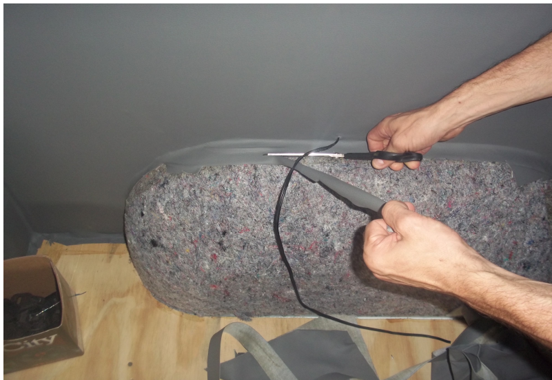
Figura 23-Revestimento das laterais do veículo durante a transformação e personalização Fotografia-Simoni Castro Lessa Variza, (2013)
