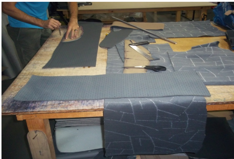
Figura 56-Risco e corte dos tecidos Fotografia-Simoni Castro Lessa Variza, (2013)
