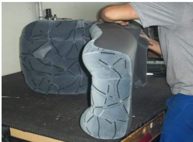
Figura 13-Montagem das capas automotivas Fotografia-Simoni Castro Lessa Variza, (2013)
