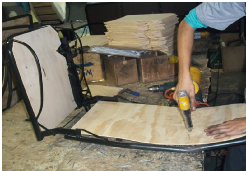
Figura 8-Revestimento com compensado de 4mm. Fotografia-Simoni Castro Lessa Variza, (2013)
