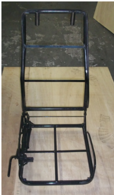
Figura 6-Carcaça de banco produzida no setor solda Fotografia-Simoni Castro Lessa Variza, (2013)
