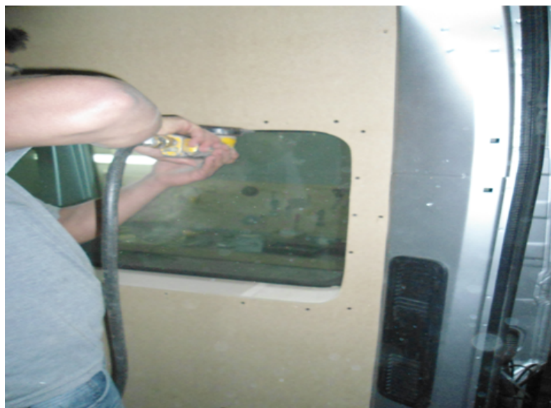
Figura 18-Revestimento com compensado nos veículos Fotografia-Simoni Castro Lessa Variza, (2013)
