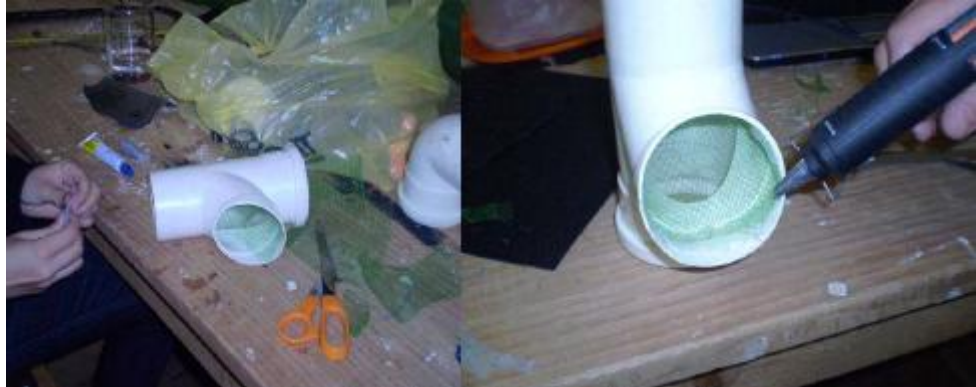
Figura 10 Preparação junção PVC para confecção do filtro e colagem da tela mosquiteiro.
