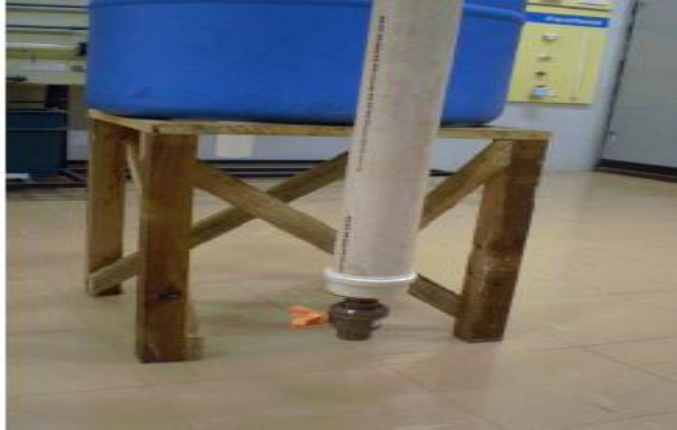
Figura12: Reservatório temporário da primeira água da chuva e regulador da quantidade de descarte da primeira água de chuva.
