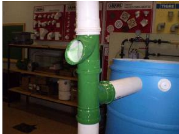
Figura 11: Junção do filtro de descarte e tê para desvio da água da primeira chuva
