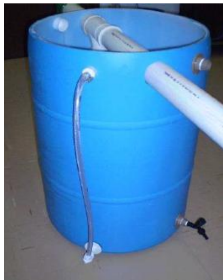
Figura 18: Mangueira para visualização do nível da água na cisterna.
