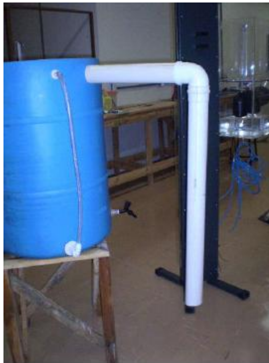
Figura 19: Extravasor ou saída para uma nova cisterna.
