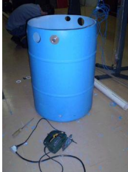
Figura 9: Abertura para o posicionamento da tubulação de 75mm.
