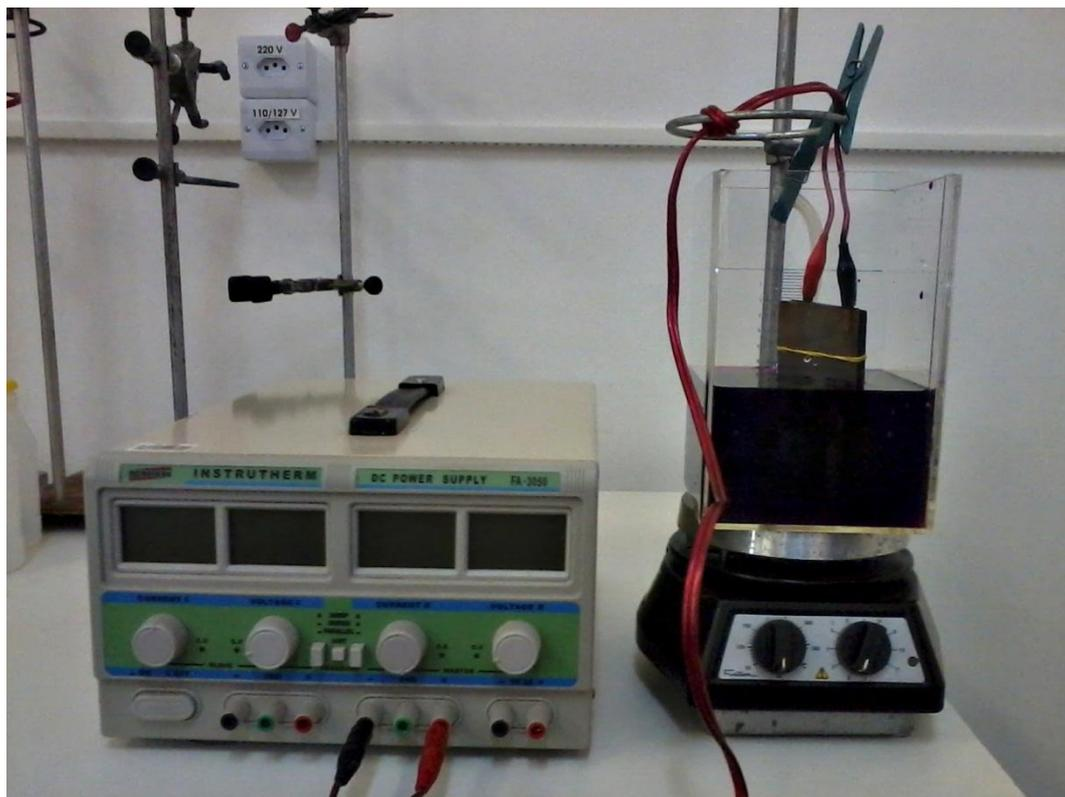
**Figura 4. Módulo experimental de eletrofloculação.**
