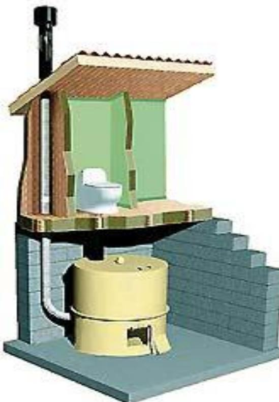
**Figura 3 - Vaso sanitário e compartimento com as câmaras de compostagem.**
