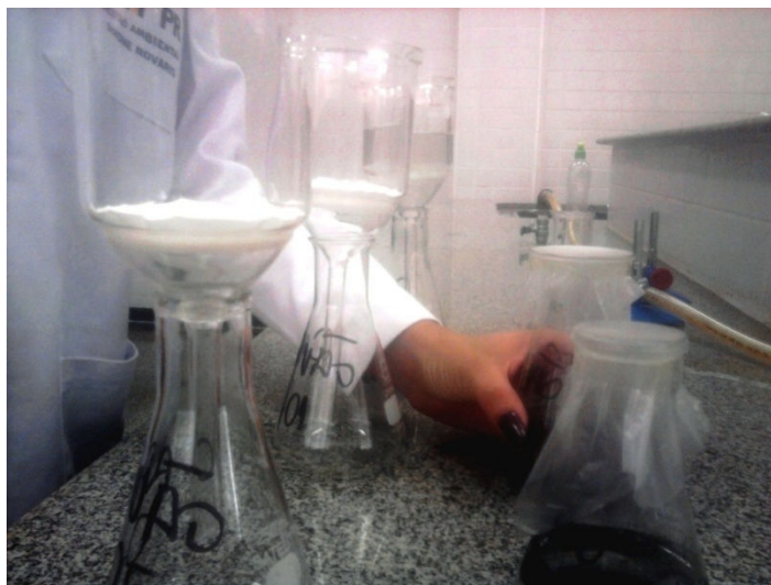
Figura 13 - Processo de Filtragem do Efluente Tratado. Fonte: As autoras.
