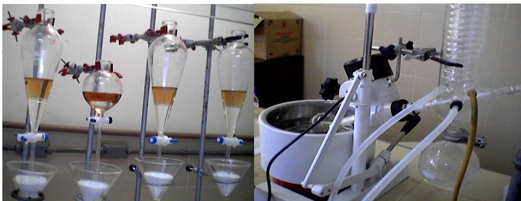
**Figura 17: Separação das frações e redução do clorofórmio em rotadestilador**
