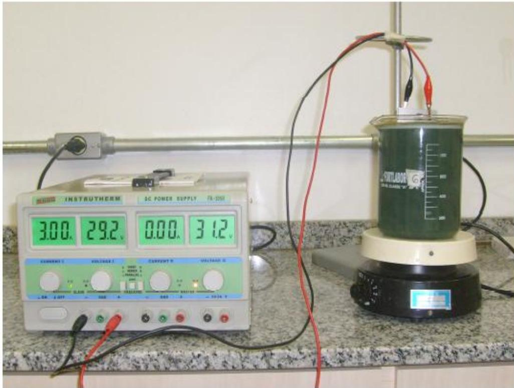
Figura 4 - Montagem experimental para realização da eletrofloculação
