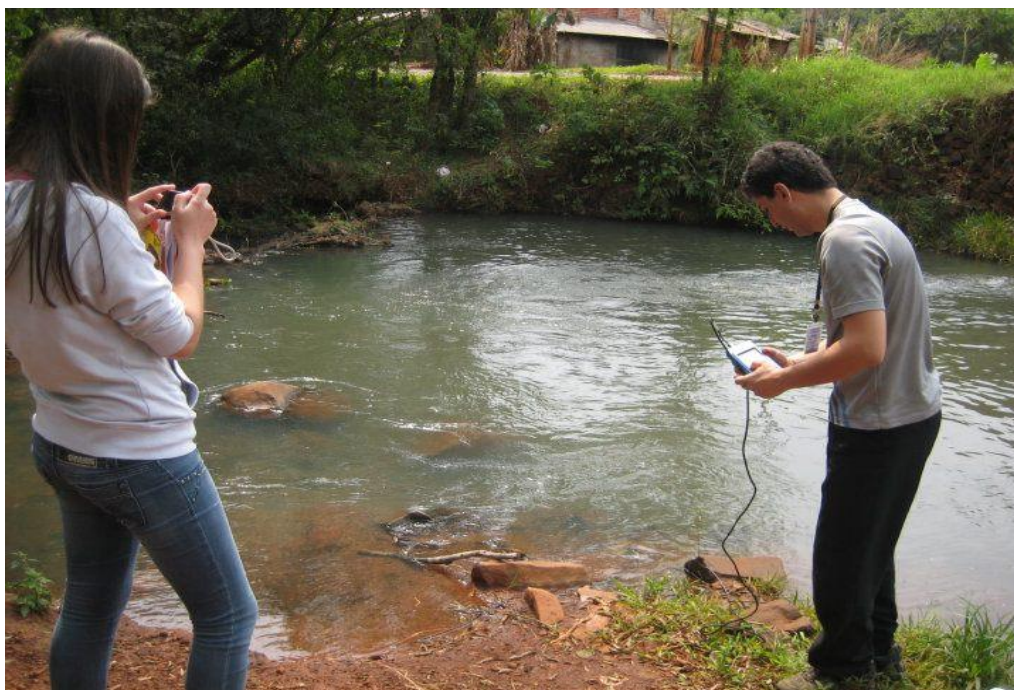
Figura 8 – Medidor portátil sendo utilizado para a medição de temperatura em um dos pontos da coleta.
