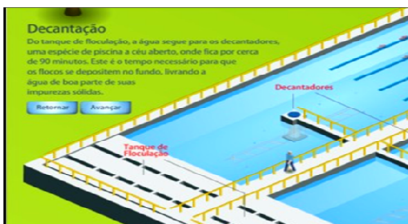
Figura 3: Etapa de decantação da água Fonte: Companhia de Saneamento do Paraná (SANEPAR)
