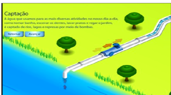
Figura 1: Etapa de captação da água Fonte: Companhia de Saneamento do Paraná (SANEPAR)
