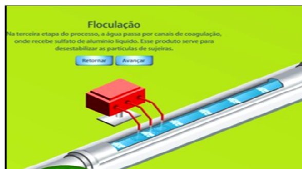
Figura 2: Etapa de floculação da água Fonte: Companhia de Saneamento do Paraná (SANEPAR)
