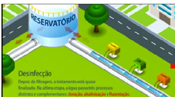
Figura 5: Etapa de desinfecção da água Fonte: Companhia de Saneamento do Paraná (SANEPAR)
