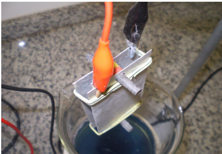
Figura 2 – Sistema da montagem dos eletrodos.
