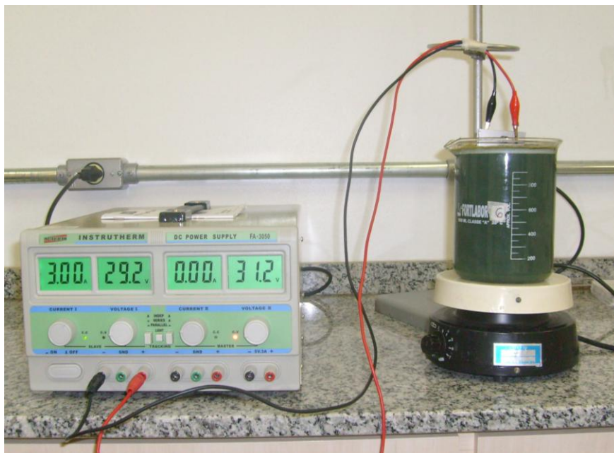
Figura 3- Montagem experimental para realizar a eletrofloculação.
