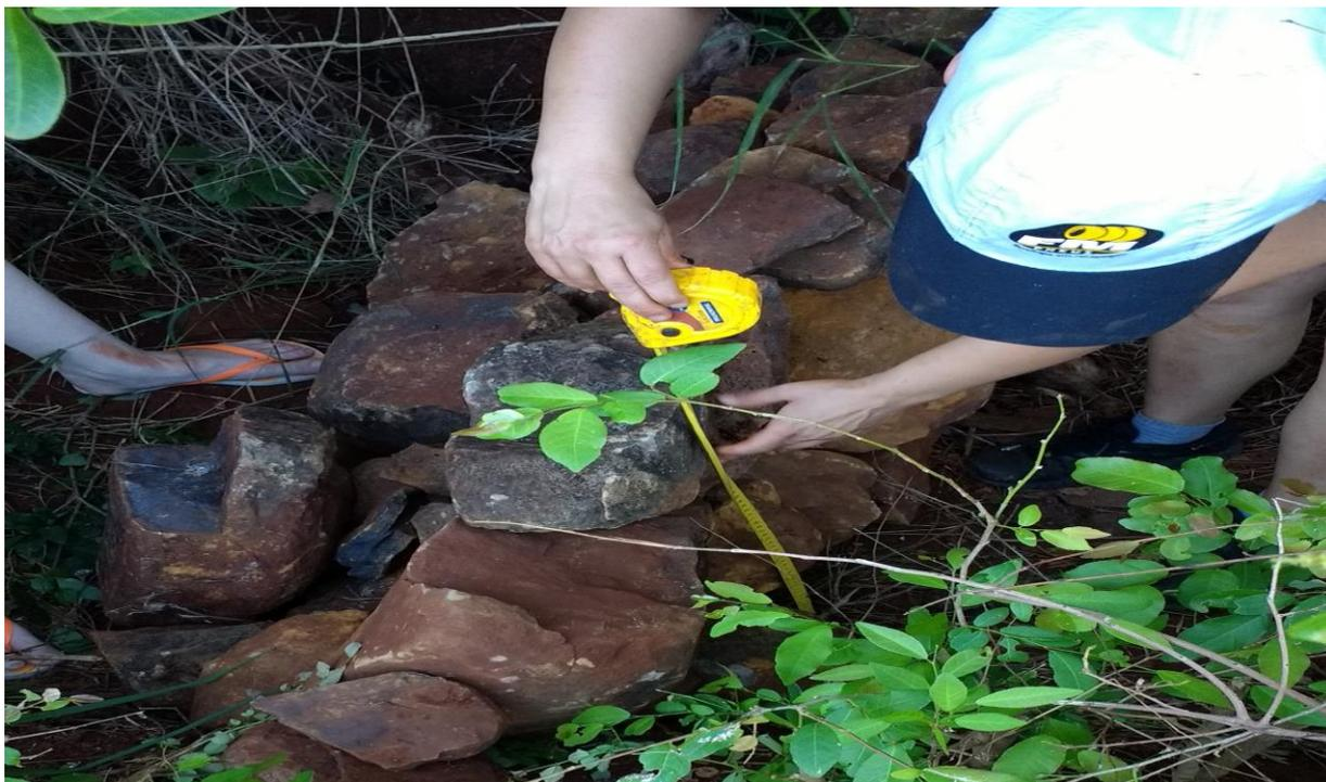
**Figura 12: Medição da barreira de 80 cm de altura por 60 cm de largura**
