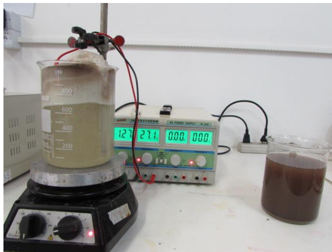
Figura 3 - Módulo experimental para o tratamento de efluente por eletrofloculação.
