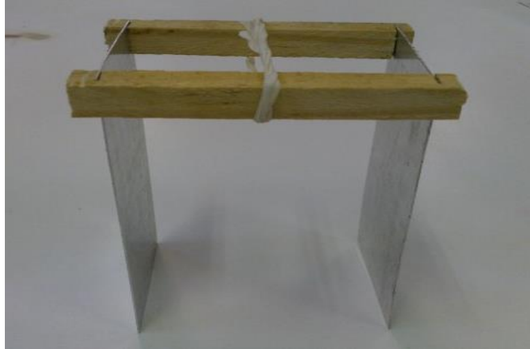
Figura 4 – Eletrodo Monopolar de Alumínio e o dispositivo de espaçamento.
