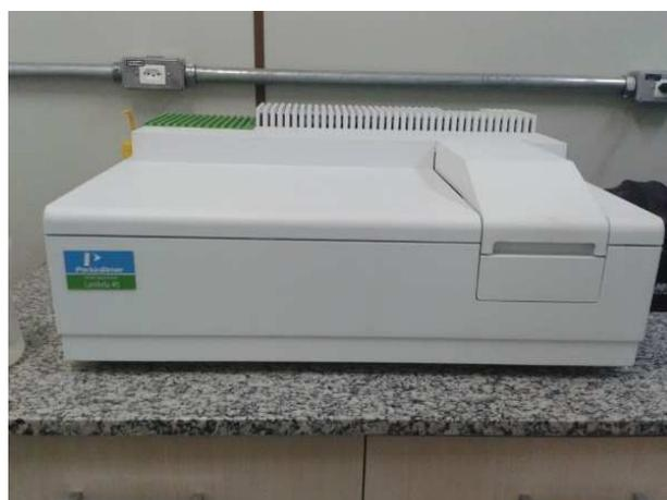
**Figura 6 - Espectrofotômetro UV-VIS Lambda 4S PerkinElmer**
