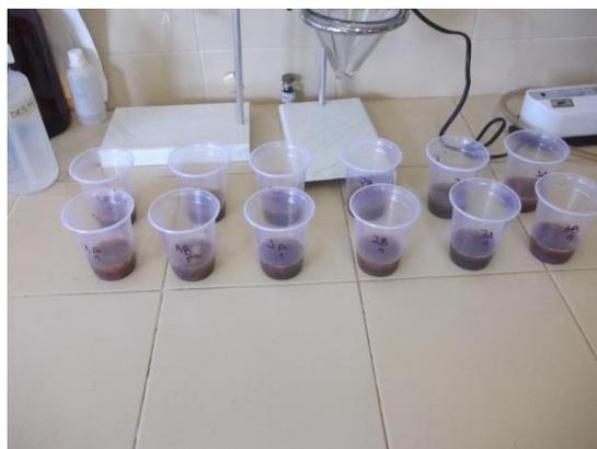
Figura 6 - Diluição para medição do pH
