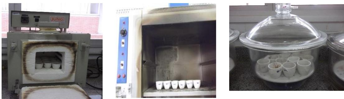
Figura 5 – Determinação da umidade a) mufla, b) estufa, c) dessecador
