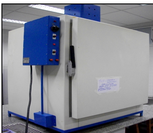
Figura 5A - Estufa de circulação de ar utilizada para teste de umidade.
