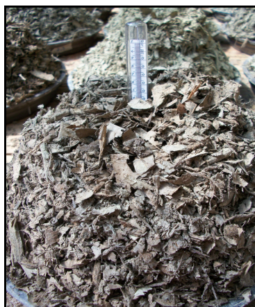
Figura 8 - Monitoramento da Temperatura no interior das leiras
