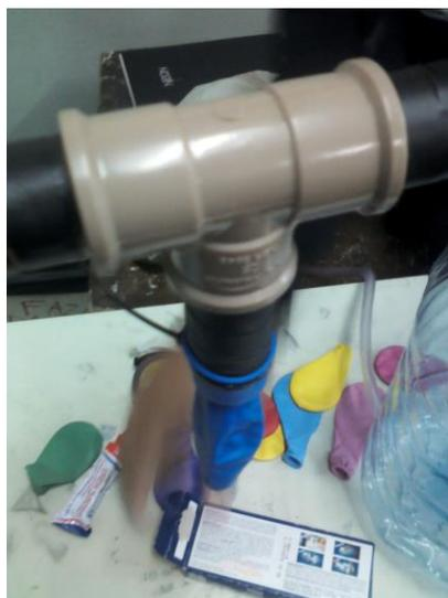
**Figura3: Estrutura em T colada às extremidades e bexiga com braçadeira.**
