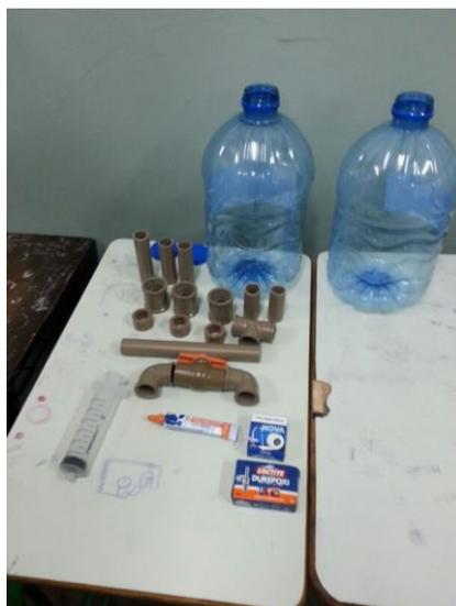
**Figura2: Materiais para fabricação do Biodigestor.**
