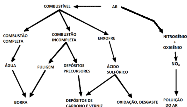
Figura 3.11 – Combustão e contaminantes do óleo lubrificante. Adaptado de Caines e Haycock (2004).
