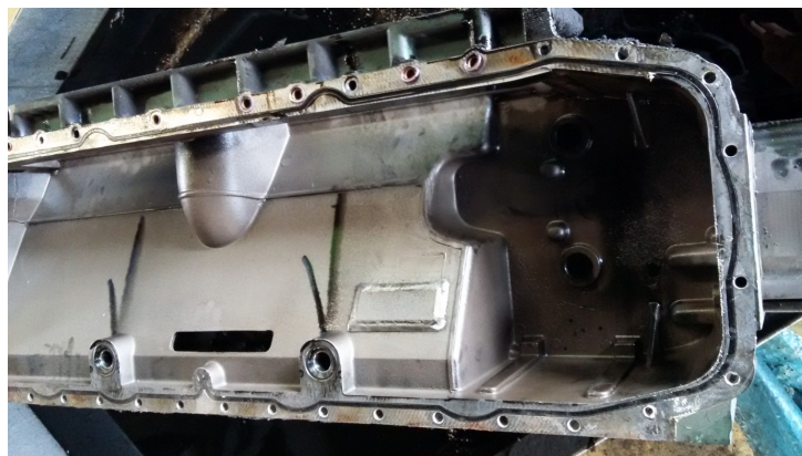
Figura 5.21 – Tampa do cárter do motor. Pequena quantidade de fuligem acumulada no lado direito.
