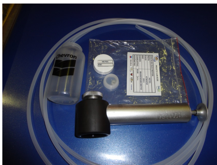
Figura 4.4 – Conjunto Frasco, mangueira e bomba de sucção para coleta de amostra de óleo lubrificante.
