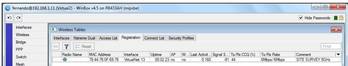
Figura 64: Site survey 5GHz balneário Itatiaia com a antena 5817CPE - RouterOS
