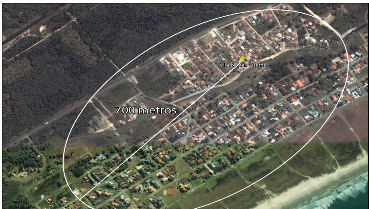
Figura 54: Site survey 5GHz balneários Vila Nova e Atami
