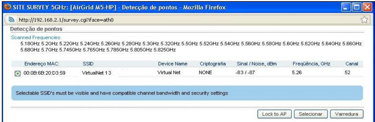
Figura 61: Site survey 5GHz balneário Itatiaia com a antena airgrid M5
