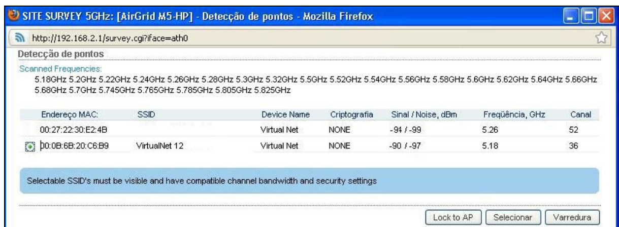
Figura 46: Site survey 5GHz ponto de embarque com a antena airgrid M5
