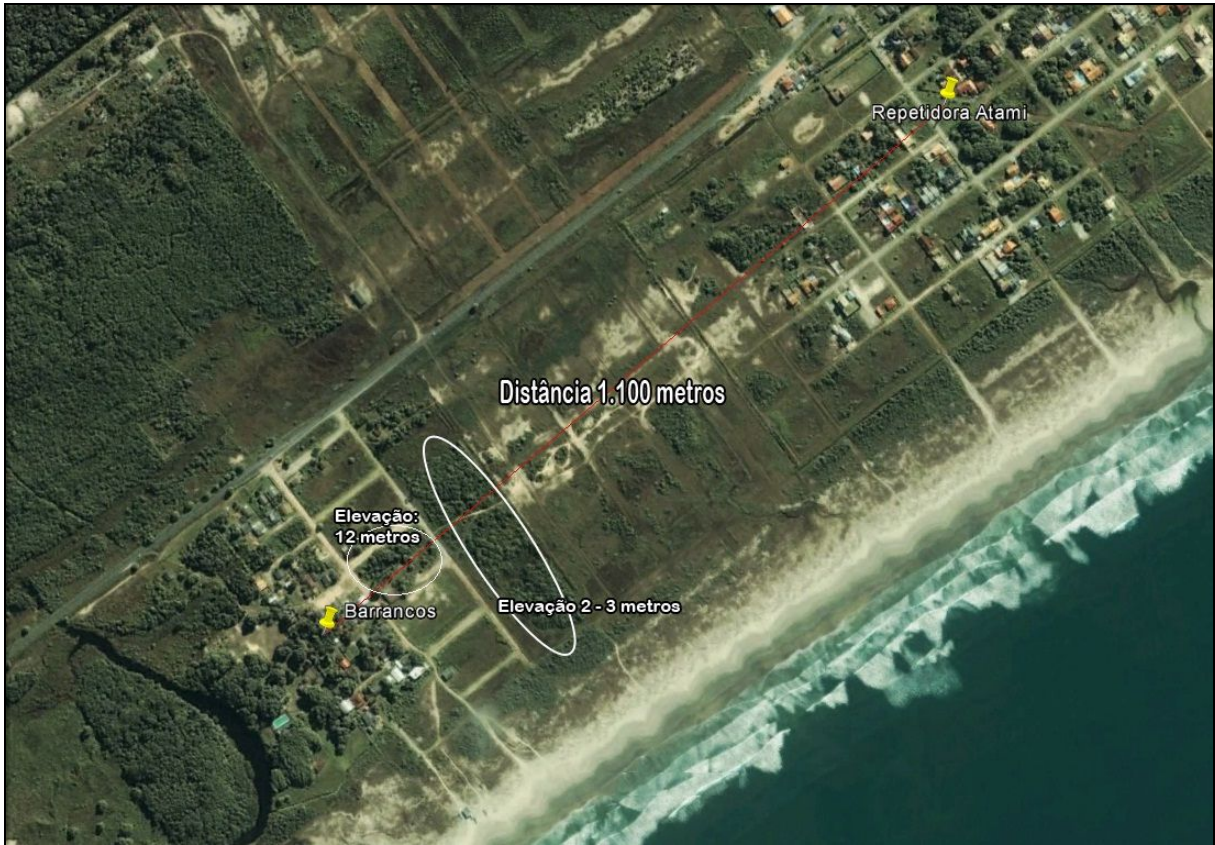
Figura 60: Site survey 5GHz balneário Barrancos
