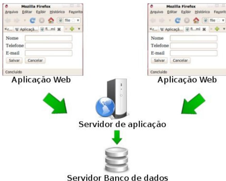
**Figura 7 - Arquitetura de servidor de aplicação.**
