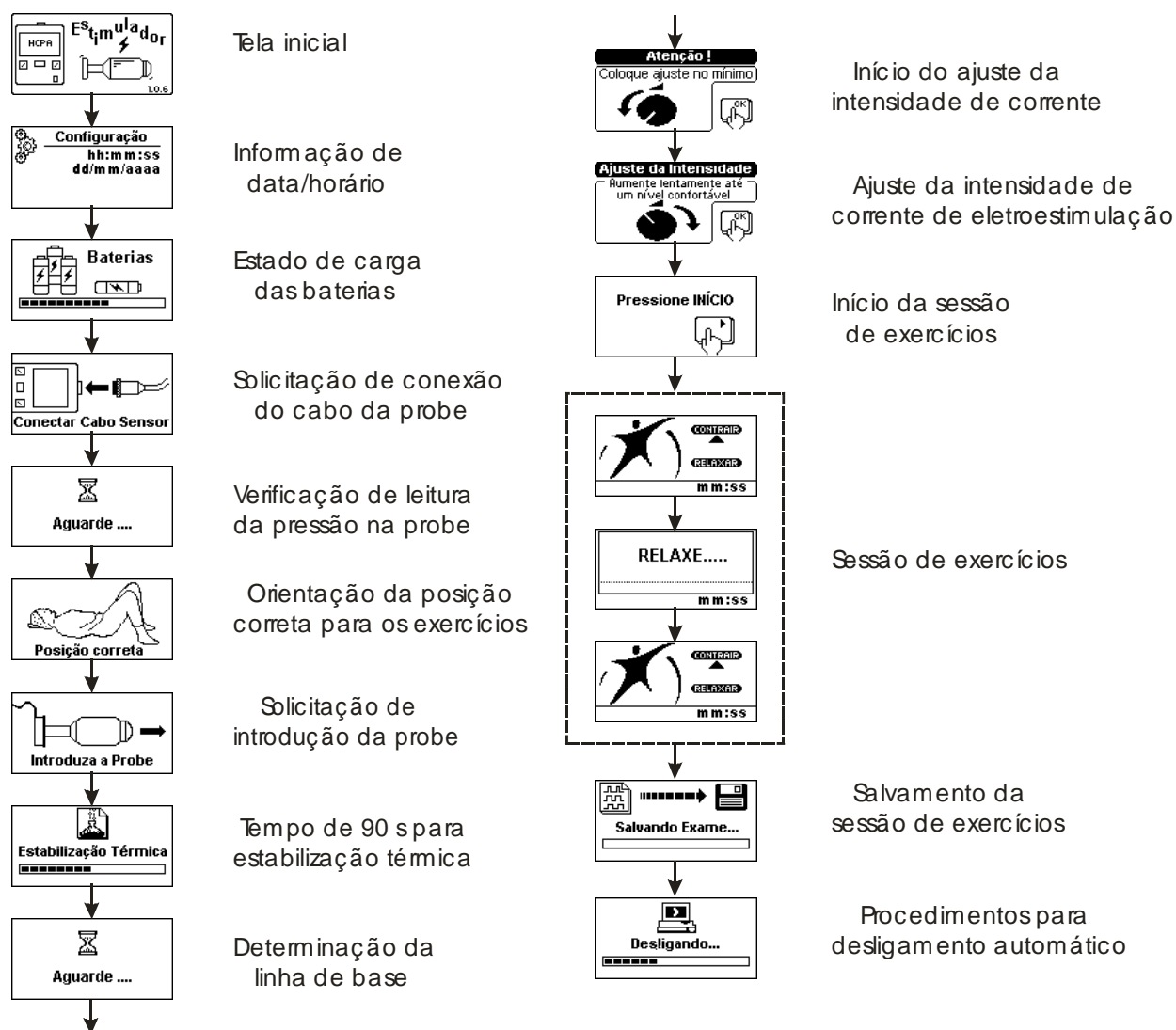
Figura 43: Seqüência de telas apresentadas à paciente com o equipamento na opção estimulação elétrica gatilhada.
