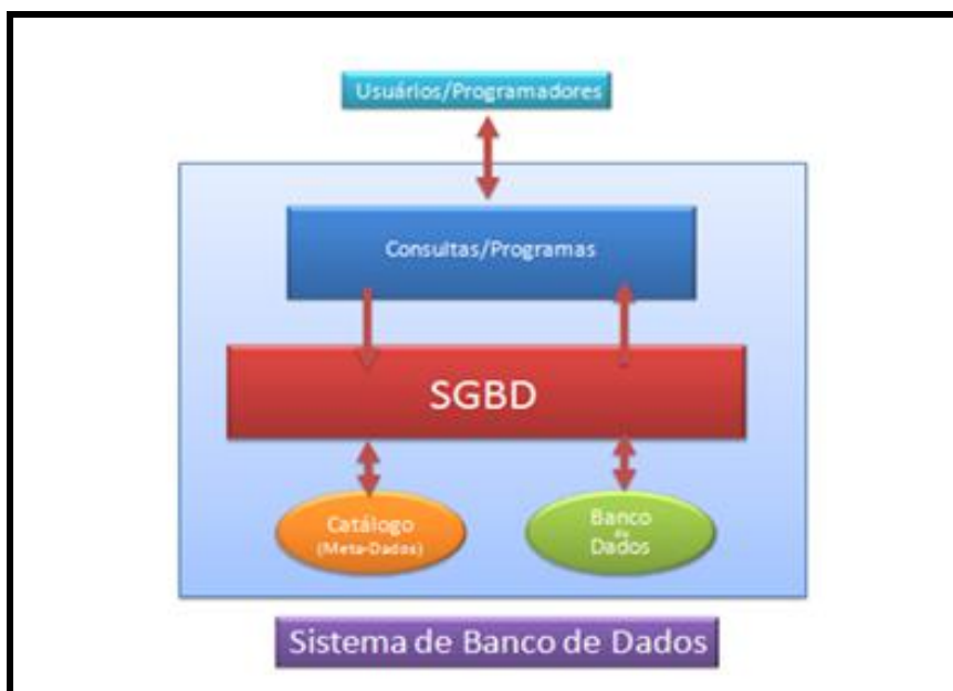
Figura 7 - Representação do acesso a um Banco de Dados Fonte: Poucodetudo.com, Os Melhores Programas Banco de Dados.
